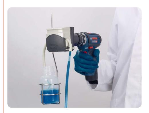
QAQC LAB POWER LIQUID SAMPLER
